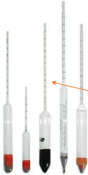
تسمح مقاييس الكثافة الزجاجية المثقلة بالرصاص بقياس كثافة سائل ما بغمس مقياس كثافة نظيف وجاف في أنبوب اختبار مملوء بسائل.
